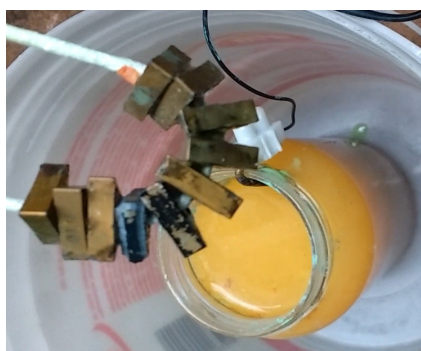
Figura 27 – Insertos montados ao eletrodo
