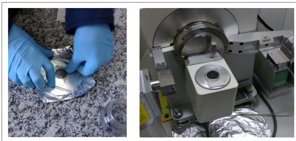
Figura 25 – Análise DRX (Preparação das amostras)
