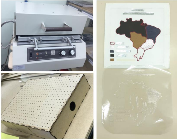
Figura 6 - Máquina termomodeladora comercial e outra confeccionada com MDF e material acessível feito com essa ferramenta
