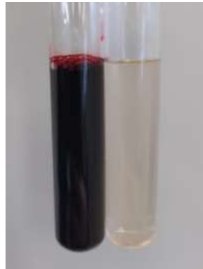
Figura 4: Resultado visual do processo adsorptivo do corante vermelho
