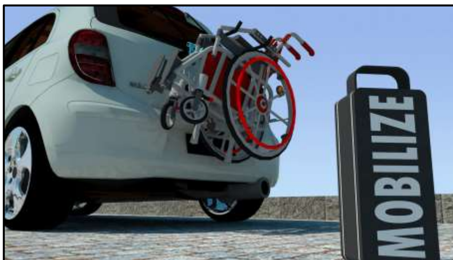
Imagem 2: Protótipo do suporte de cadeira de rodas adaptável a automóveis desenvolvido pela MOBILIZE. Fonte: Equipe Mobilize/IFRJ
