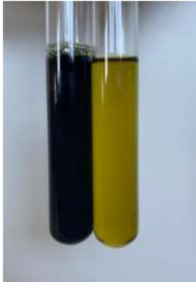
Figura 2: Resultado visual do processo adsorptivo do corante verde
