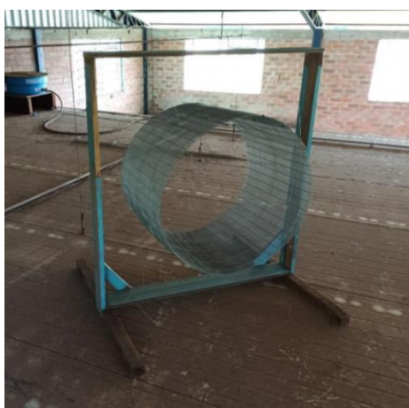
Figura 3: Estrutura metálica tipo Gaiola de Faraday
