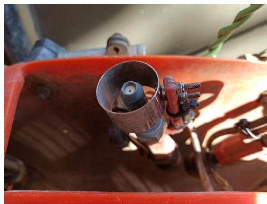
Figura 2: Ponta de pulverização e anel de indução de carga
