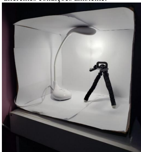
Figura 10 - Cabine fotográfica desenvolvida para a captura de imagens para a avaliação dos corantes em diferentes condições ambiente.
