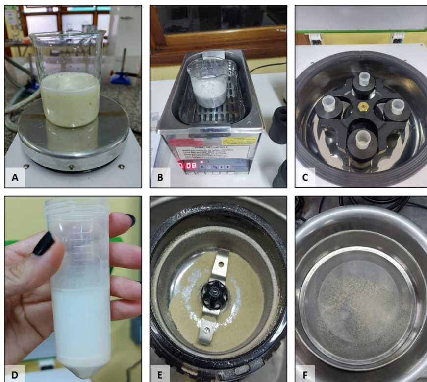
Figura 18. Etapas envolvidas no método de emulsão com etapa lavagem – A: Agitação magnética 600 rpm por 3 h. B: Processo de ultrassom. C: Processo de centrifugação. D: Híbrido após centrifugação. E: Trituração do híbrido após secagem de 8 h a 110 °C. F: Etapa de peneiração do híbrido seco.
