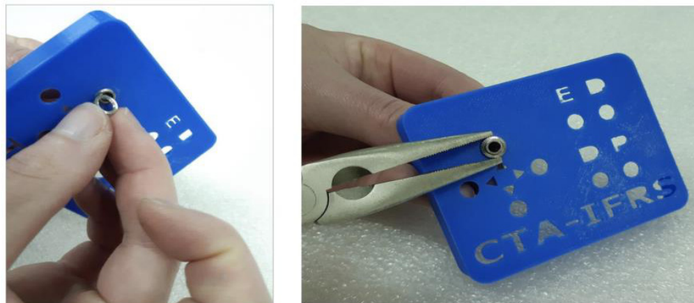
Figura 12 - Montagem dos Jacks J2 nos furos da caixa
