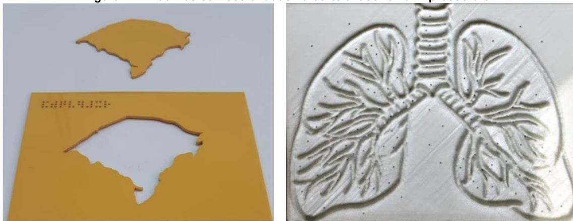
Figura 17 - Matrizes confeccionadas na corte a laser e na impressora 3D
