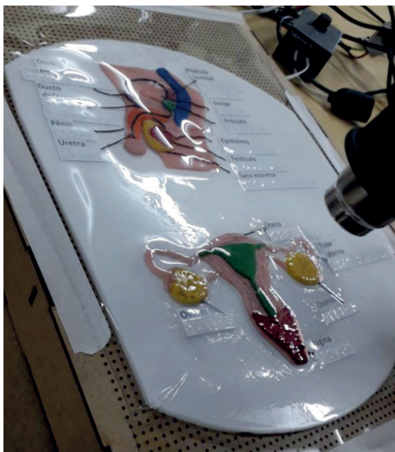
Figura 1 - Lâmina de acetato sendo aquecida para adquirir o formato da matriz (material tátil sobre o sistema reprodutor feminino e masculino)
