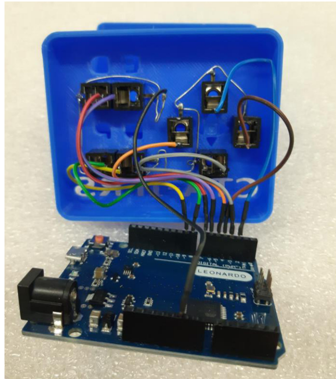
Figura 17 - Arduino Leonardo conectado a todos Jacks J2 da caixa
