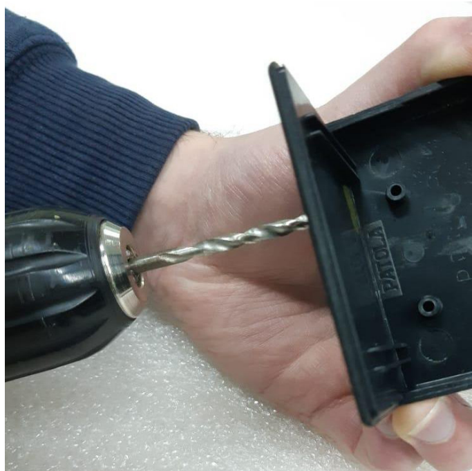
Figura 11 - Realização dos furos no local marcado na Figura 10
