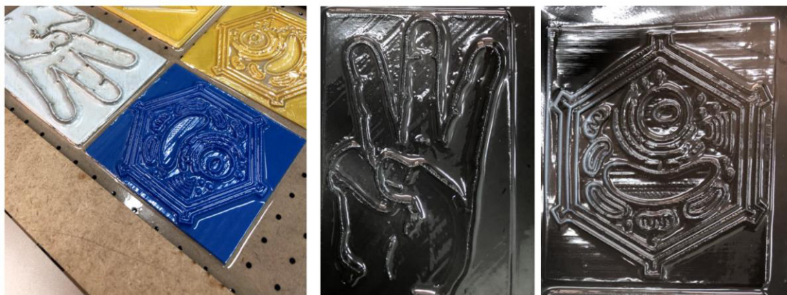
Figura 24 - Resultado final da confecção de material acessível na termoformadora
