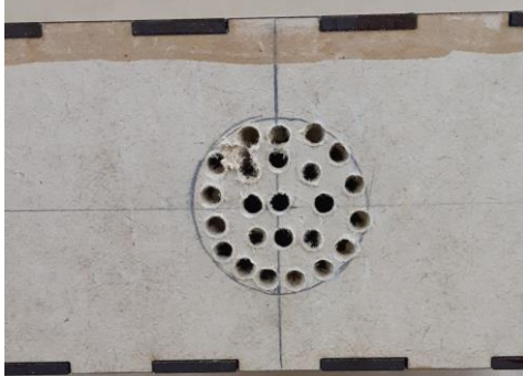
Figura 11 - Furações na área do furo lateral
