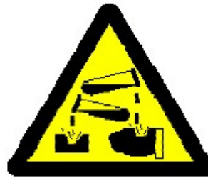
Perigo - Substâncias Corrosivas
